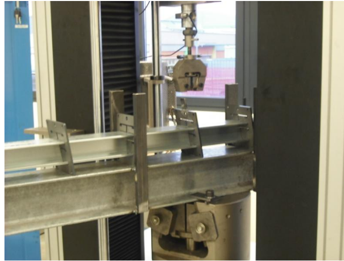
Simulazione di un ciclo di compressione su particolare finito
